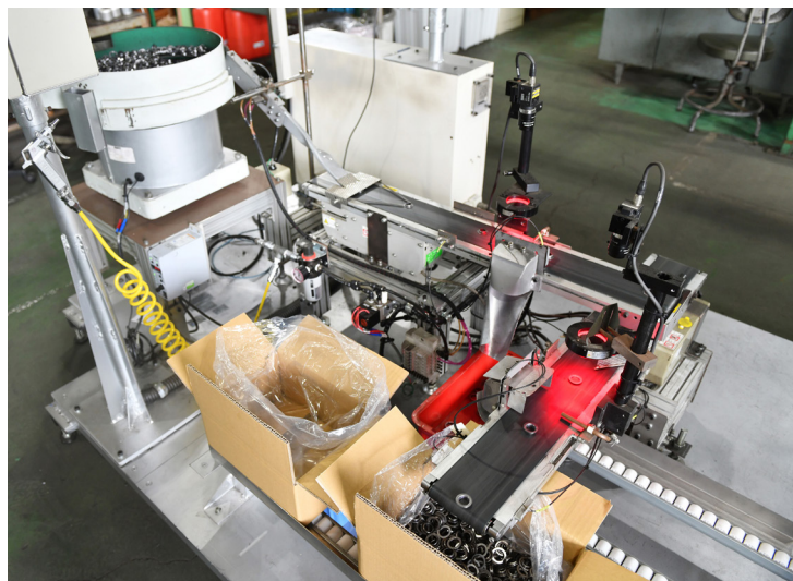
部品をカメラで撮影し、検品の効率を大幅に向上した設備を従業員が開発した。
